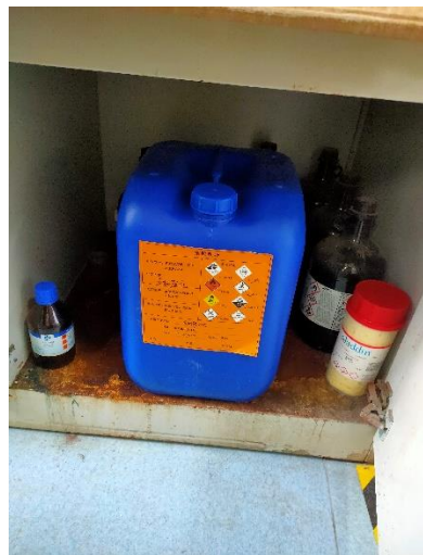
生科楼 C6005—废液桶无防溢托盘，负责人陈凯（左图为初查，右图为复查）
