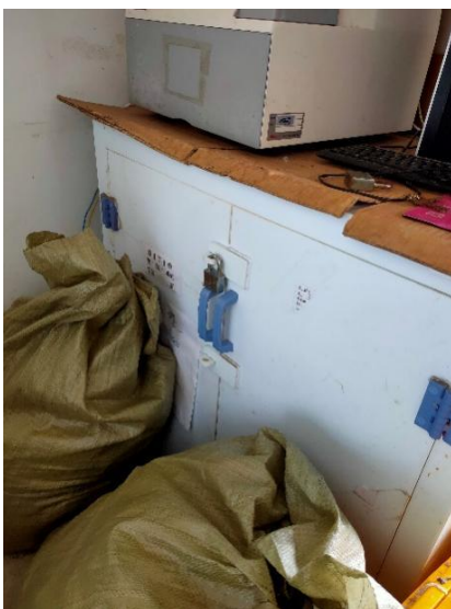
生科楼 C6016—危化品柜未双人双锁管理，只装有一把锁。负责人崔仲利（上图为初查，下图为复查）
