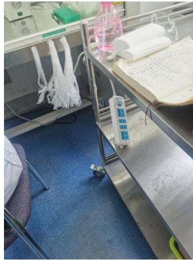
理科楼 A801-803—灭火器未配置架子、无点检记录卡；接线板悬空使用；负责人王卓然（复查新增）
