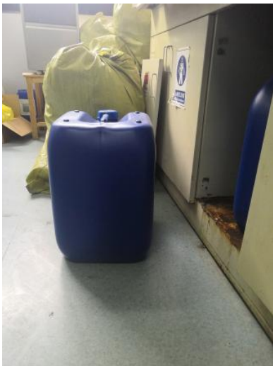
生科楼 C6005—废液桶无防溢托盘，负责人陈凯（左图为初查，右图为复查）
